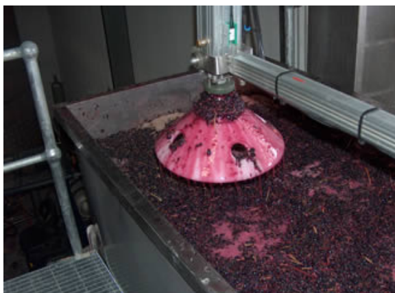
Tanque em fermentação com pisa robotizada.
